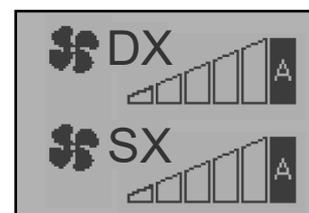
Lorsque la température ambiante atteint la valeur réglée sur le poêle (AFFICHE TEMP-SET), le poêle entre en Modulation et le ventilateur (F, DX, SX) fonctionne à un minimum.
