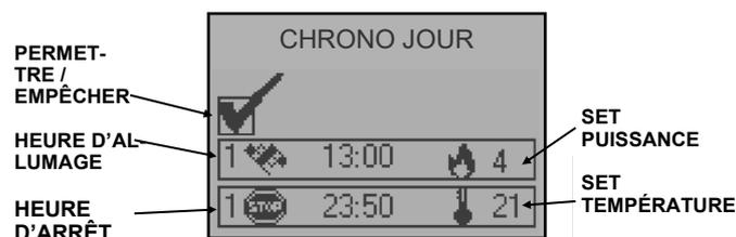
Vous pouvez définir les secteurs opérationnels définis par les temps de réglage. Le réglage **OFF** permet à l'horloge d'ignorer la commande.
