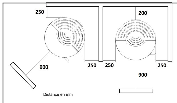
**Attention: Pour certains modèles, les distances minimales de sécurité à partir de matériaux inflammables peuvent être inférieures à ceux rapportés dans la figure suivante, il est donc recommandé de toujours consulter l'étiquette du produit généralement placé à l'arrière du poêle pour assurer les distances minimales de sécurité liées au modèle spécifique.**
