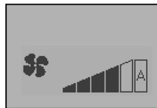
S'il est réglé sur A (Automatique), les ventilateurs de chauffage fonctionneront à une vitesse définie en fonction du niveau de puissance de combustion sélectionné.
