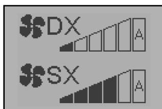
Lorsque la température ambiante atteint la valeur définie (AFFICHE TEMP.AMB), le poêle passe en mode Normal Modulation, le ventilateur F fonctionne au minimum et les ventilateurs DX et SX continuent de fonctionner indépendamment en fonction de la puissance réglée (DX, SX).
