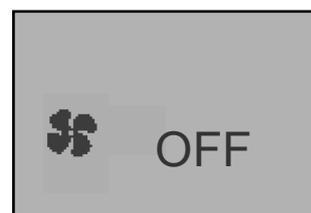
**Note :** en cas de température élevée des fumées, les ventilateurs seront activés de manière autonome par mesure de sécurité afin de refroidir le corps du poêle.
