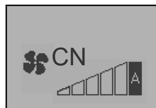
Lorsque la température ambiante atteint la valeur réglée sur le poêle (AFFICHE TEMP-SET), le poêle entre en Modulation et le ventilateur (F, CN) fonctionne à un minimum.
