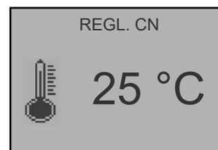
Lorsque la température ambiante atteint la valeur réglée sur le poêle (AFFICHE TEMP-AMB), mais que ce n'est pas le cas pour la température SET (REGL. CN) du CN, le poêle continue de fonctionner à la puissance réglée (AFFICHE PUISSAN), le ventilateur F fonctionne au minimum et le ventilateur du CN continue de fonctionner à la puissance du poêle.
