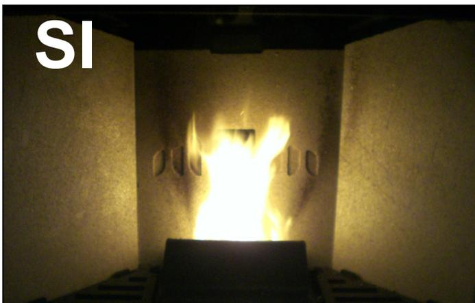
Combustione **OTTIMALE**, la fiamma è viva di un colore giallo/bianco con una minima quantità di pellet nel braciere. Non è necessario modificare alcun valore nel menu Taratura.
