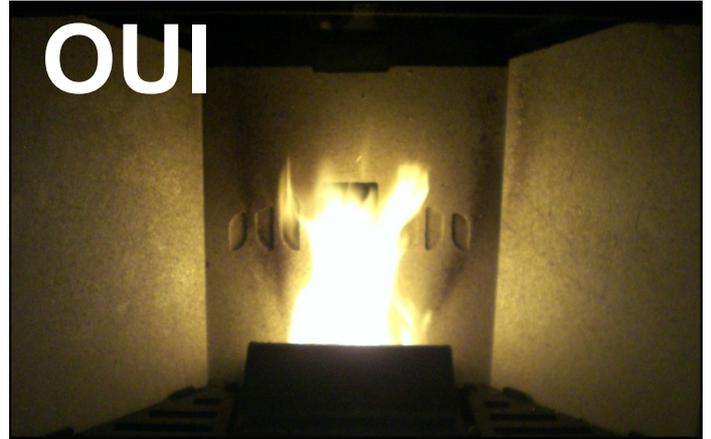
Combustion **OPTIMAL**, la flamme est vivante avec une couleur jaune/blanc avec une petite quantité de pellet dans le brasier. Il n'est pas nécessaire de modifier une valeur dans le menu **TARATURE**.
