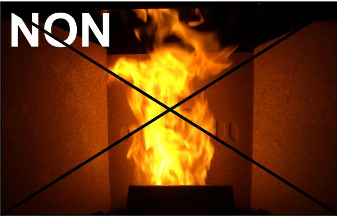
Combustion **PAS OPTIMAL**, la flamme est élevée et faible d'une couleur orange avec des quantités élevées de pellet imbrûlés dans le brasero.
