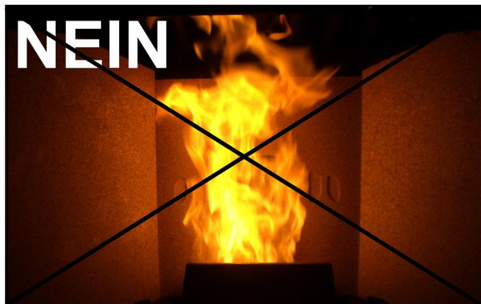
**NICHT OPTIMALE** Verbrennung, die Flamme ist hoch und schwach und orangefarben mit einer großen Menge an unverbrannten Pellets im Brenner.
