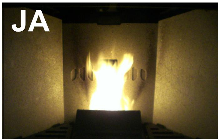
**OPTIMALE** Verbrennung, die Flamme ist lebendig von einer gelb / weißen Farbe mit einer kleinen Menge brennender Pellets im Inneren des Brenners. Es ist nicht notwendig, irgendwelche Einstellungen im **KALIBRIERUNG** menü vorzunehmen.
