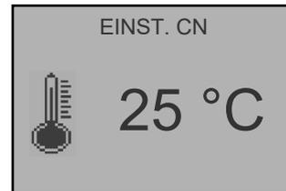
Wenn die Raumtemperatur den am Ofen eingestellten Wert erreicht (SET RAUMTEMP), aber nicht die SET - Temperatur des CN Gebläse (EINST. CN), arbeitet der Ofen mit der eingestellten Leistung (SET LEISTUNG) weiter, der Ventilator F arbeitet auf Minimum und der CN-Ventilator arbeitet weiter mit der am Ofen eingestellten Leistung.
