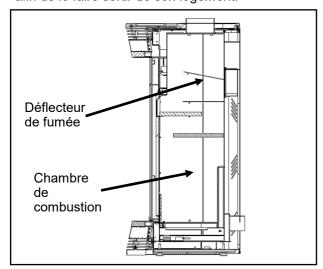
Le poêle doit être nettoyé au moins une fois par an (après la saison de chauffage) ou plus fréquemment en cas d'usage intensif ou d'utilisation d'un combustible de mauvaise qualité; le poêle doit toujours être froid avant le nettoyage.
