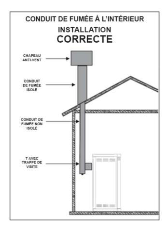
Pour le raccordement au conduit de fumée, il est conseillé d'utiliser des tubes en acier inox conformes aux normes en vigueur, sans réductions, et avec une inclinaison maximale de 45°. Il est recommandé de ne pas utiliser de matériaux métalliques flexibles ni de fibrociment.
