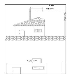
Les parties extérieures du conduit de fumée doivent obligatoirement être isolées, afin d'éviter tout phénomène de condensation et la formation de créosote sur les parois internes du conduit, qui à la longue en réduisent la section et donc sa capacité d'évacuation des fumées.
