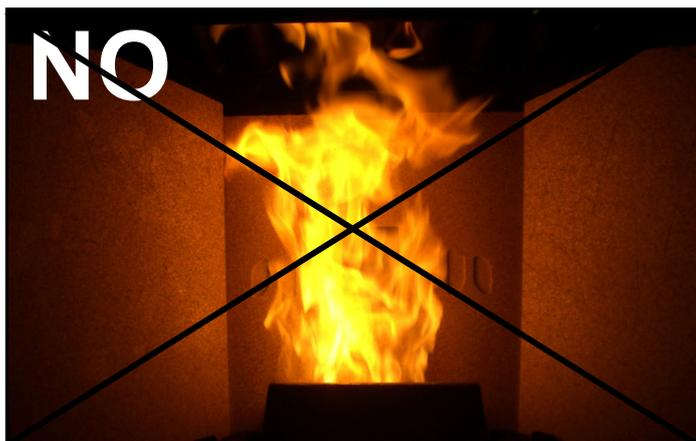
Combustione **NON OTTIMALE**, la fiamma è alta e debolmente arancione con elevata quantità di pellet incombusti nel braciere.
