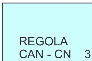
Quando la temperatura ambiente raggiunge il valore impostato (SET TEMP AMBIENTE), la stufa va in Modulazione, la ventola F lavora al minimo e la ventola CN continua a lavorare in modo indipendente a seconda della potenza impostata (CN).
