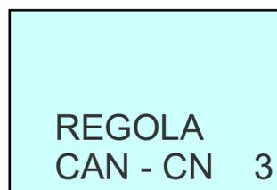
Quando la temperatura ambiente raggiunge il valore impostato sulla stufa (SET TEMP AMBIENTE), la stufa va in Modulazione e le ventole (F, CN) lavorano al minimo.
