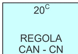
Quando la temperatura ambiente raggiunge il valore impostato sulla stufa (SET TEMP AMBIENTE), ma il SET di temperatura (REGOLA CN) relativa alla CN no, la stufa continua a lavorare alla potenza impostata (SET POTENZA), la ventola F lavora al minimo e la ventola CN continua a lavorare alla potenza impostata sulla stufa.
