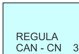
Cuando la temperatura ambiente alcanza el valor configurado en la estufa (AJUSTE TEMP. AMBIENTE), la estufa entra en Modulación y los ventiladores (F, CN) funcionan al mínimo.
