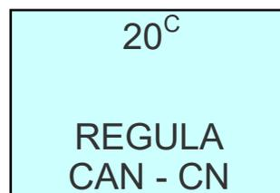
Cuando la temperatura ambiente alcanza el valor configurado en la estufa (AJUSTE TEMP. AMBIENTE) pero el AJUSTE (REGLA CN) correspondiente a CN no, la estufa continúa trabajando a la potencia configurada (AJUSTE DE POTENCIA), el ventilador F trabaja al mínimo y el ventilador CN continúa trabajando a la potencia configurada en la estufa.
