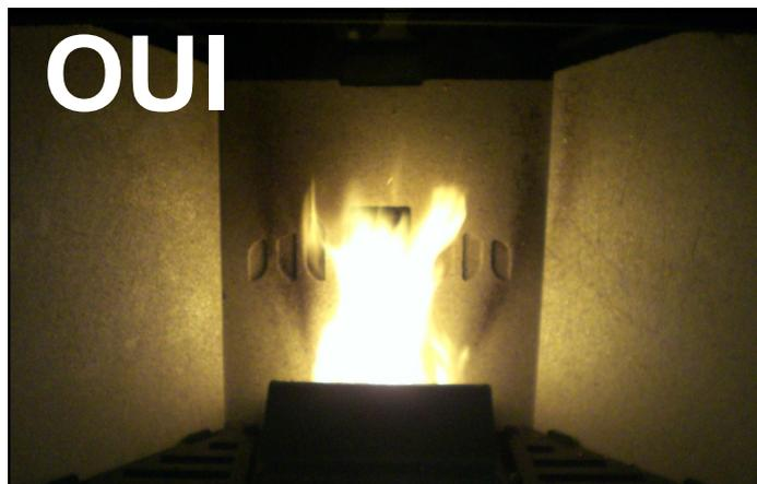
Combustion **OPTIMALE**, la flamme est vivante avec une couleur jaune / blanc et avec une petite quantité de pellet dans de brasier. Il n'est pas nécessaire de modifier une valeur dans le menu **CALIBRAGE**.
