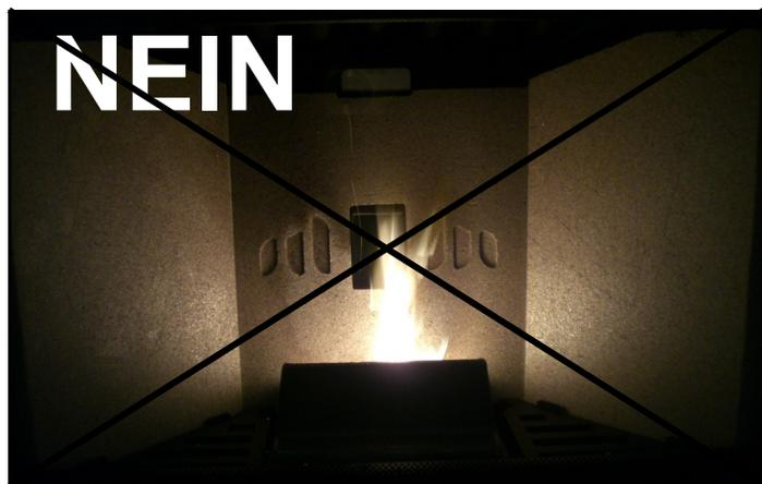
**Nicht-OPTIMALE** Verbrennung, die Flamme ist zu eng, und eine große Menge glühender Pellets fliegt aus dem Brenner.
