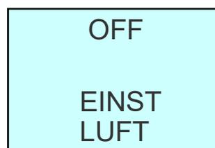
**Hinweis:** Bei hoher Abgastemperatur werden die Ventilatoren aus Sicherheitsgründen automatisch aktiviert, um den Ofenkörper zu kühlen.
