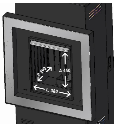
FIGURE 10 – Dimensions de la chambre de combustion
